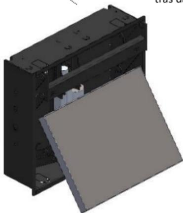
Não há ajuste de rotação, é **IMPORTANTE** que o seu CORTE esteja NIVELADO, REQUADRADO E LIMPO. Tenha cuidado para não danificar ou rasgar o papel que se encontra na parte de trás da parede de gesso.
